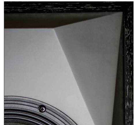
Die rundum angefasste Schallwand des Koaxialtreibers verhindert Beugungseffekte.
